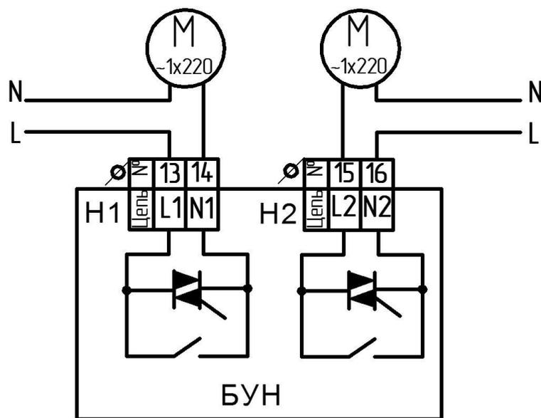
Рисунок 15 – Схема включения электронасосов
