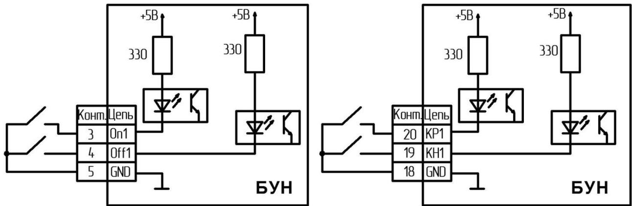
Рисунок 16 – Схема подключения внешнего управления и дискретных сигналов.
