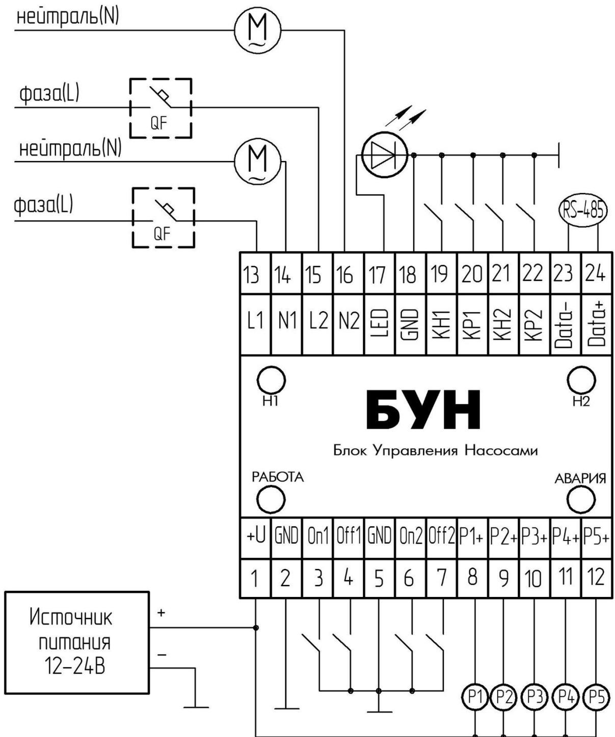
Рисунок Б.1 – Назначение клемм подключения внешних устройств
