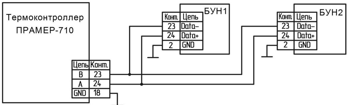
Рисунок 17 – Схема соединения термоконтроллера и БУН
